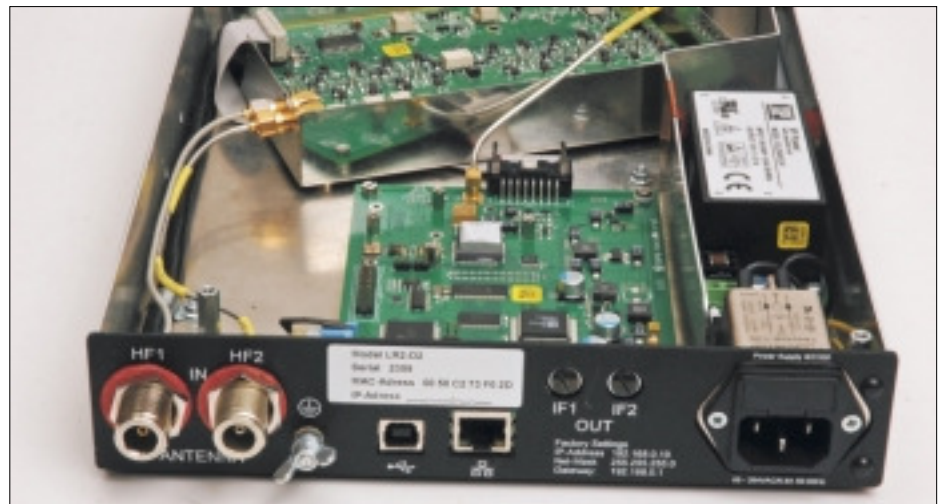
Neben den zwei Antennenbuchsen in N-Norm zeigt die Rückseite auch weitere Anschlüsse – wie für LAN und USB.
