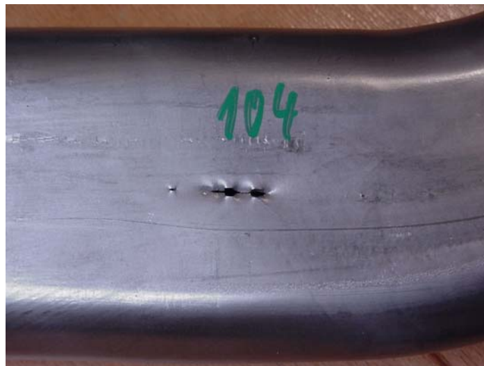
Abbildung 1: Ausschnitt eines innenhochdruckumgeformten Rohres mit kleinem Sternriss
