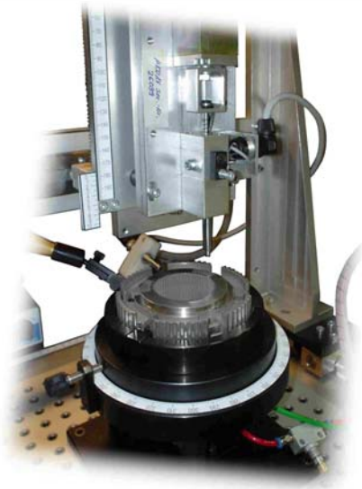
Abbildung 1: Beispiele für das Prüfnest eines rotationssymmetrischen Bauteils mit Mikrofon (links) und für ein linienintegriertes Dachziegelprüfsystem mit Laservibrometer (rechts).
