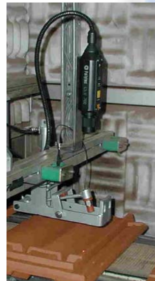
Abbildung 1: Beispiele für das Prüfnest eines rotationssymmetrischen Bauteils mit Mikrofon (links) und für ein linienintegriertes Dachziegelprüfsystem mit Laservibrometer (rechts).
